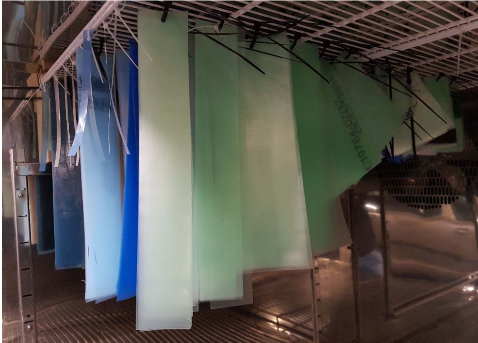
FIGUR 5. Membran og membransystemer samt samlinger af membraner med bånd af butyl hængt til accelereret ældning.
