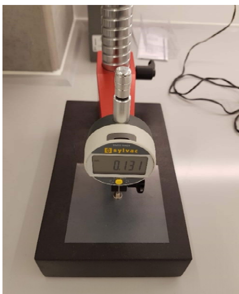
FIGUR 17. Sylvac apparat til måling af membrantykkelse.
