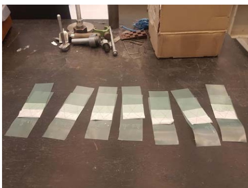
FIGUR 52. Afrivningsform for tapet samling. Billedet til venstre er PE-membransystem T7482-6 og billedet til højre er PE-membransystem T7482-4.
