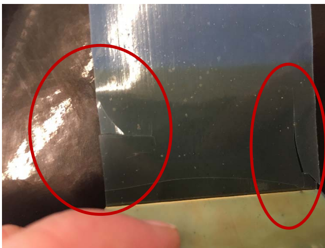
FIGUR 55. Knækket plast, for ældet PE-membran T7482-8.
