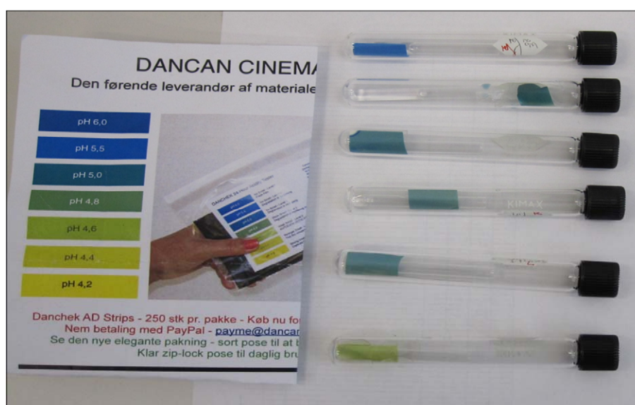
FIGUR 7. A-D indikatorer viser frigivelsen af organiske syrer fra plast ved at ændre farven fra blå til grøn og gul.
