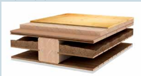
Svømmende gulv på træfiberunderlag på eksisterende gulvbrædder
