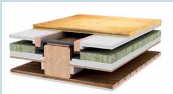
Bærende gulv på stålbeslag eller hattebeslag
