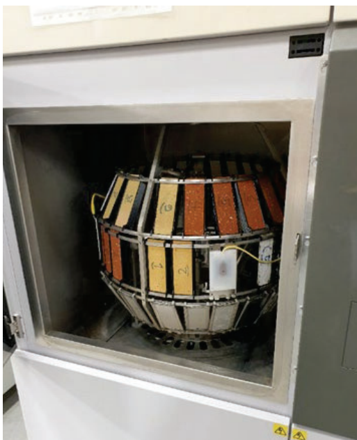
FIGUR 43. Forsøgsopstilling med acceleret ældning, hvor prøverne blev udsat for 635 gentagelser af vandpåvirkning og UV-stråling. Foto: Vasilis Soulios.
