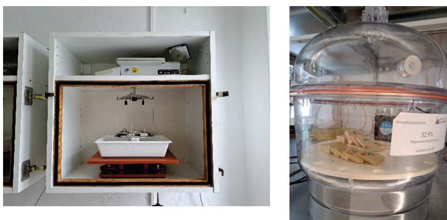
FIGUR 46. a) Forsøgsopstilling for bestemmelse af kapillær opsugning og mætningsvandindhold. b) Forsøgsopstilling for bestemmelse af ligeveægtsfugtindhold. Foto: Panagiota Pagoni
