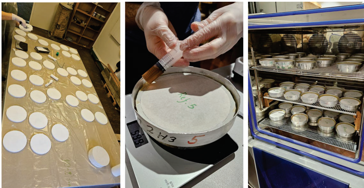
FIGUR 49. Maling af forsøgsemner, monteringen af prøverne i "kopperne" og opstilling af kopper i klimakammeret. Foto: Nickolaj Feldt Jensen og Panagiota Pagoni (billedet i midten)
