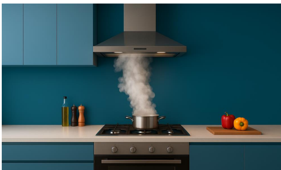
Figur 13. Jo større luftmængde, jo bedre fjernes partiklerne og jo tættere placering af emhætten på forureningskilden, jo mere effektiv er den [Johannsen et al. 2023]. Figurkredit: AI
