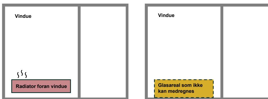
Figur C.5. Glasareal som ikke kan medregnes bag blokering (her radiator).
