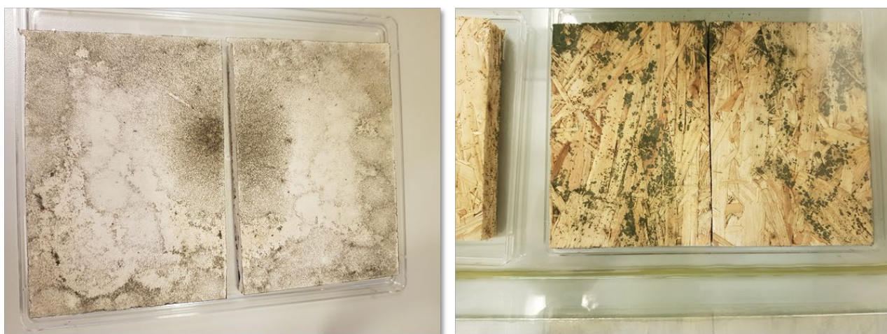
Figur 11. Naturligt forekommende Stachybotrys chartarum på gips (tv) og Chaetomium globosum på OSB (th). (Foto: Birgitte Andersen).
