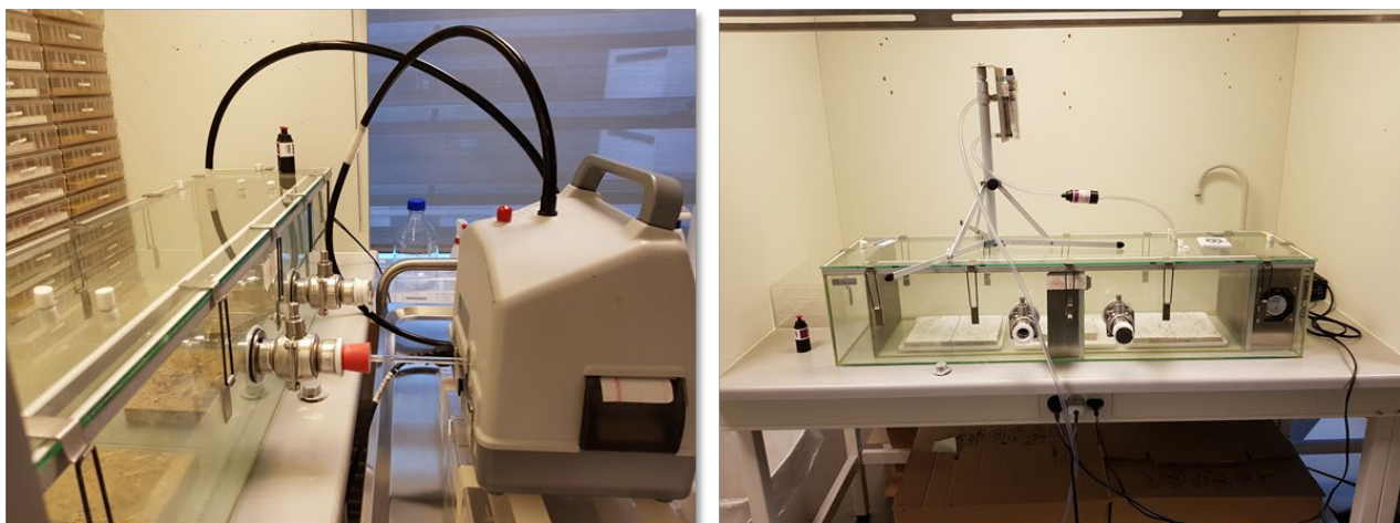
FIGUR 7. Forsøgsopstilling til partikelmåling (tv), hvor afkastet fra Lasair II recirkuleres gennem luftindtag (med den røde prop), og Mycometermåling (th), hvor luftindtaget er åbent til laboratorieluften. I begge opstillinger tages prøverne i M4 i M2-M5 rækken i låget. (Foto: Birgitte Andersen).
