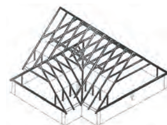
Vinkeltage med hanebåndsspær er typisk anvendt, hvor taget er indrettet til boligformål eller til tørrelofter og pulterrum i de ældre etageejendomme.
