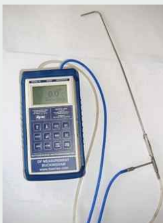
Figur 2 – Manometer med tilhørende pitotrør
