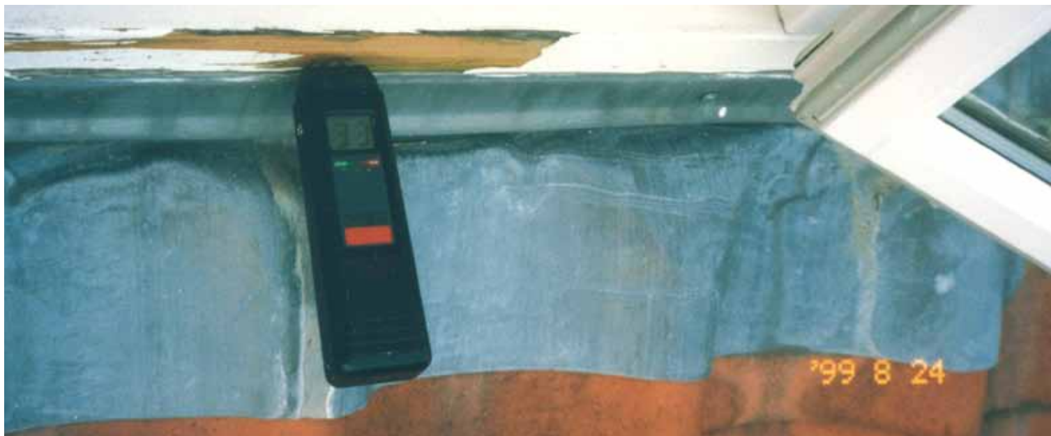
Fugtmåling i karm til kvistvindue
