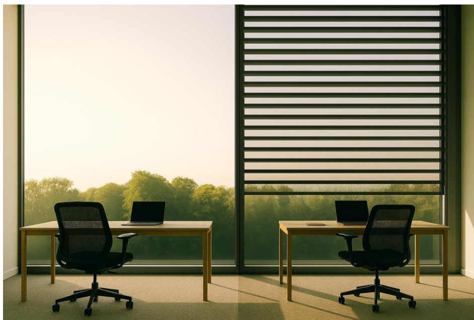
Figur F.1. Solafskærmning påvirker både udsyn og dagslys, samt termisk indeklima og energiforbrug (AI-genereret billede).
