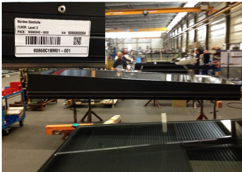
FIGUR 28. Produktionshallen hos Scheldebouw, Holland, som leverede facadeelementerne til Nordeas domicil på Amager. I øverste venstre hjørne ses mærkning af element med stregkode, så monteringsjakket fra Scheldebouw helt præcist ved, hvor elementet skal monteres. [Foto: Jens Haldager]
