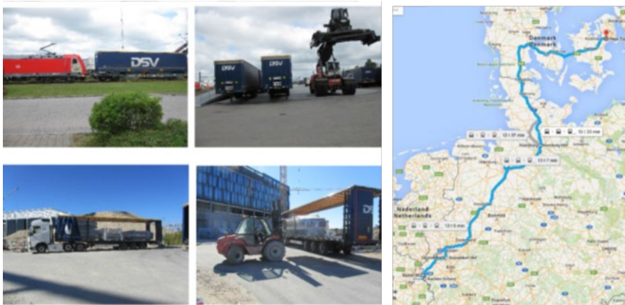
FIGUR 26. Ved lange transporter kan benyttes jernbane. Eksempel på transport af facadeelement til bygning af Nordeas domicil på Amager. Elementer blev læsset på jernbanevogn nær Scheldebouws fabrik i Holland og kørt til terminalen i Høje Taastrup, hvor de blev omlæsset til lastbiler, der kørte dem ud til byggepladsen.
